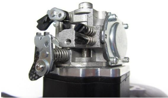
Montieren sie bei einem neuen Motor keine Ansaugtrichter-Ansaugwinkeltrichter oder sogar Luftfilter. Diese können die Laufeigenschaften auch benachteiligen. Auch Veränderungen der Vergaser Membranbelüftung oder Rumpfansaugung sollten nicht vorab gemacht werden. Betreiben sie den Motor immer erst im Originalzustand, erst dann kann man durch optionale Anbauteile einen positive Verbesserung feststellen.
